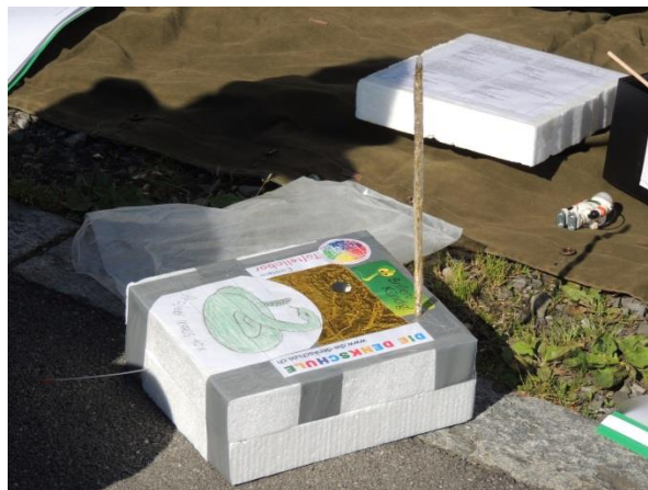
Ballonsonde enthält Filmkamera und Peilsender
