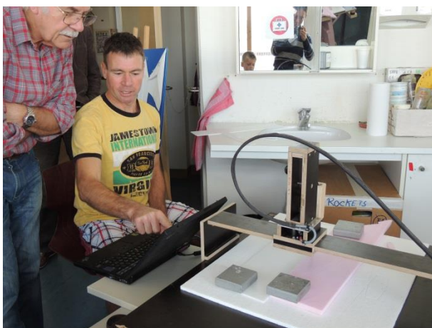
Pitri Boldt am PC und seinem CNC-Styroporschneider
